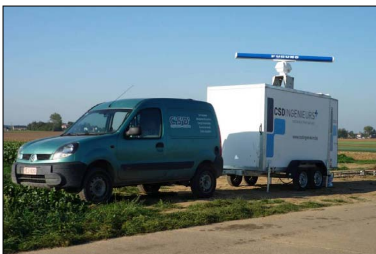
Figure 5 : L'unité mobile birdtracker de CSD : un outil de suivi ornithologique par radar X-band.
